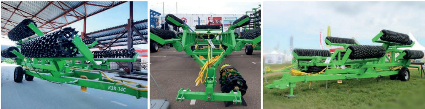
Каток представляет собой полуприцепное гидрофицированное орудие с шарнирной рамой, на которой установлены 7 батареи катков.
